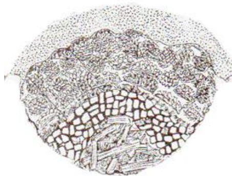
Figura 4. Horno trunco-cónico de tierra tomada de Sánchez (2005)
